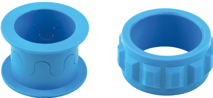
Die selbstschmierenden EP-15-Gleitlager bestehen aus einem UV-beständigen POM-Compound und widerstehen deshalb lange der starken Sonneneinstrahlung in Photovoltaikanlagen ©GGB
